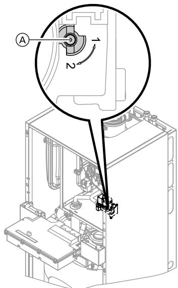
1. Установить регулировочный винт
