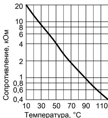
**Ремонт** (продолжение)**Проверить датчик температуры на выходе**
