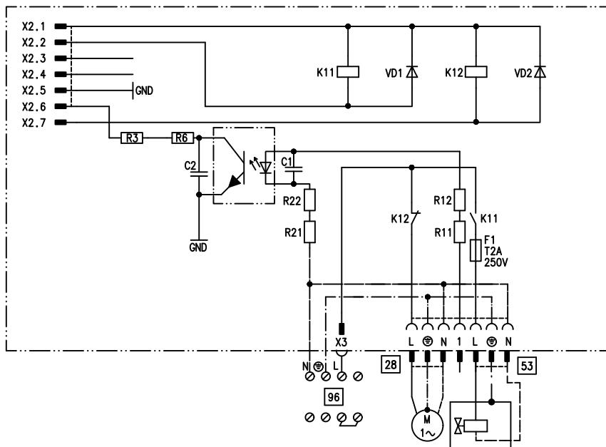
Внутренний модуль расширения Н1 интегрирован в корпус контроллера. К релейному выходу **28** подключен насос загрузки накопительной емкости.
