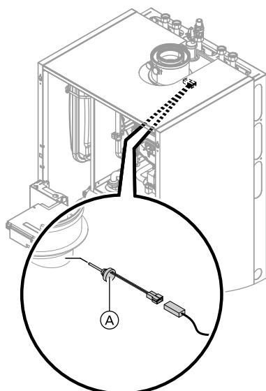
1. Отсоединить кабели от датчика температуры уходящих газов (A).
