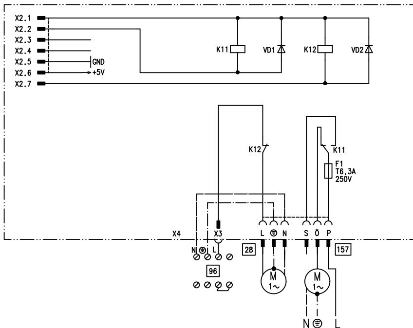
Внутренний модуль расширения H2 встраивается в корпус контроллера вместо внутреннего модуля расширения H1. К релейному выходу [28] подключен насос загрузки накопительной емкости.
