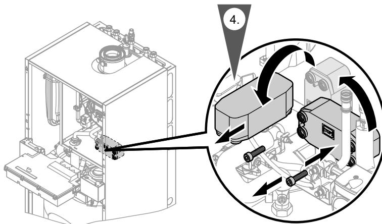
4. Открутить крепежные винты, вытянуть пластинчатый теплообменник вниз и извлечь его движением вперед.
