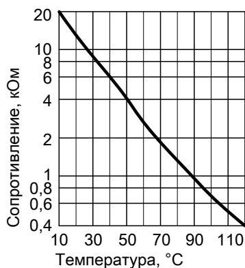
2. Измерить сопротивление датчика и сравнить его с кривой.
