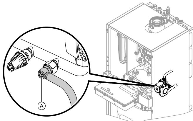
1. Закрыть запорные вентили грею- щего контура.
