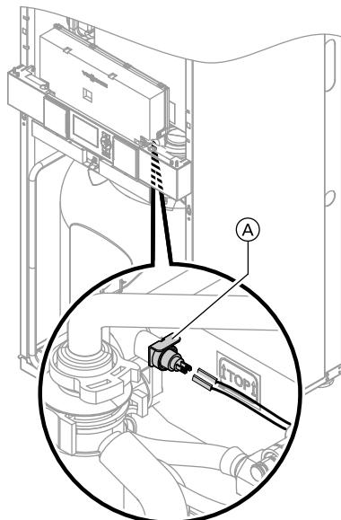
1. Отсоединить кабели от датчика температуры на выходе (A).
