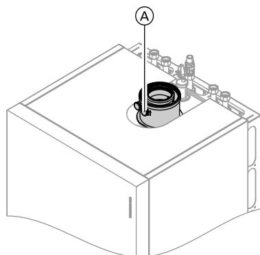
1. Подключить анализатор уходящих газов к отверстию уходящего газа (A) на присоединительном элементе котла.
