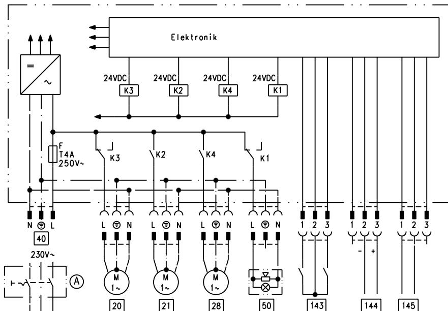
Внешний модуль расширения подключается через шину KM-BUS к контроллеру водогрейного котла. При помощи модуля расширения можно одновременно управлять указанными ниже функциями:
