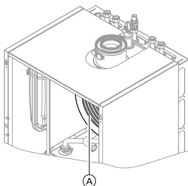
1. Удалить отложения с теплообменных поверхностей **(A)** камеры сгорания с помощью пылесоса.
