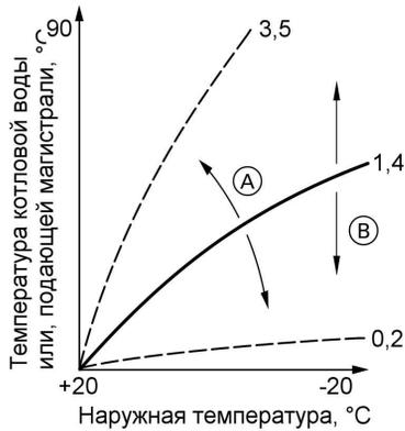
1. Изменить наклон в режиме кодирования 1 посредством кодированного адреса "d3" (см. на стр. 49). Диапазон настройки: от 2 до 35 (соответствует наклону от 0,2 до 3,5).
