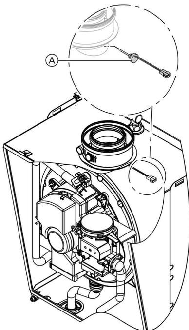
1. Отсоединить кабели от датчика температуры отходящих газов (A).
