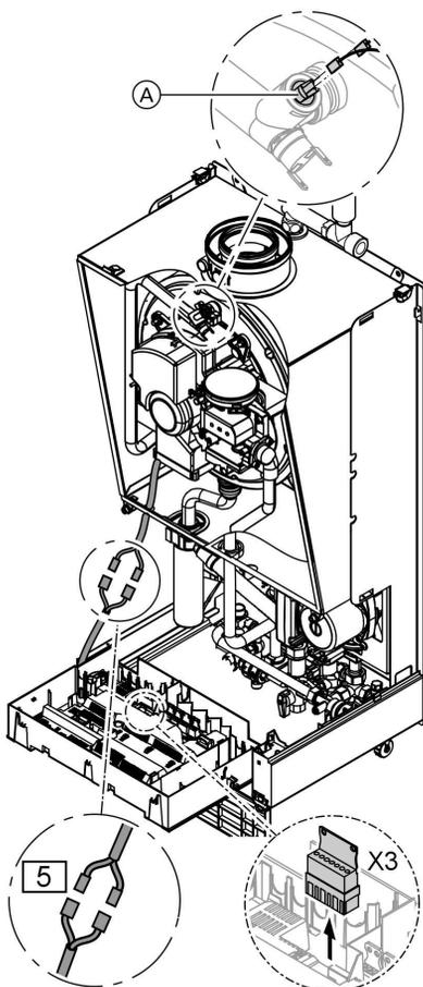
1. Датчик температуры котла: отсоединить кабели от датчика температуры котла **A** и измерить сопротивление. Датчик температуры емкостного водонагревателя: отсоединить штекер **5** от кабельного жгута на блоке управления и измерить сопротивление. Датчик температуры подающей магистрали: отсоединить штекер "X3" от контроллера и измерить сопротивление между "X3.4" и "X3.5".
