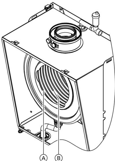
1. При необходимости очистить камеру сгорания (A) и теплообменные поверхности (B) щеткой или промыть водой.
