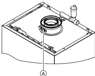
1. Подключить анализатор отходящих газов к отверстию отходящего газа (A) на присоединительном элементе котла.
