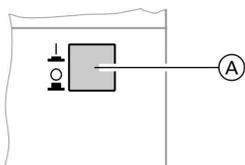
Выключить и снова включить сетевой выключатель (A) на комплекте привода смесителя. Прибор выполняет следующую самопроверку:
