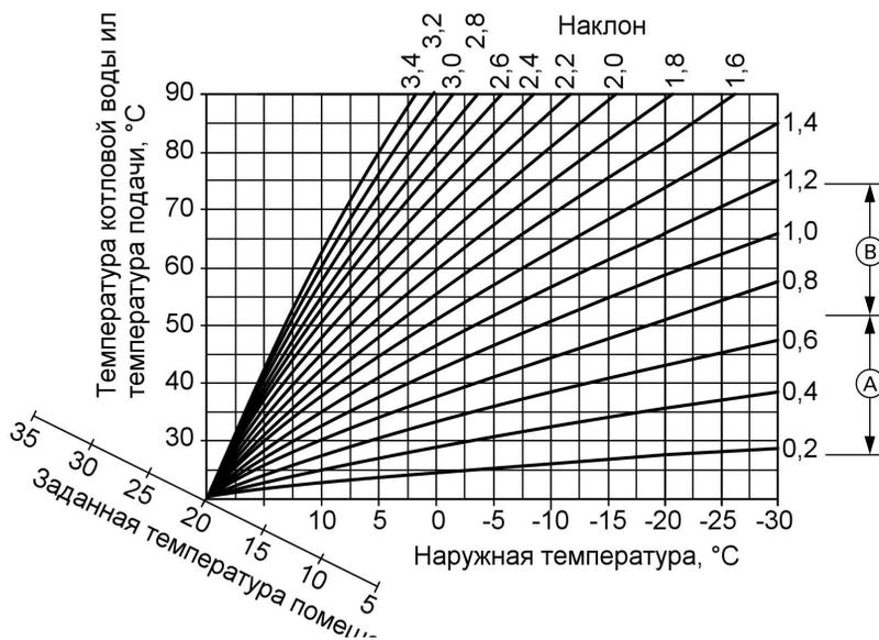
Ⓐ Наклон отопительной характеристики для систем внутреннего отопления
