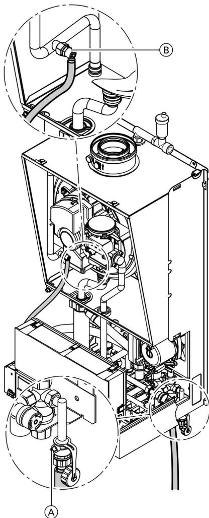
1. Закрывать запорные вентили греющего контура.
